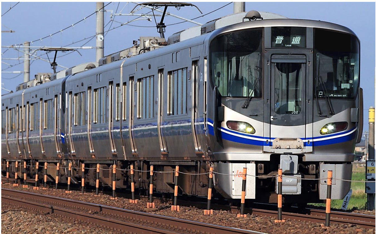
(北陸本線を走行している521系車両 定員246名(2両)、最高速度120km/h)
